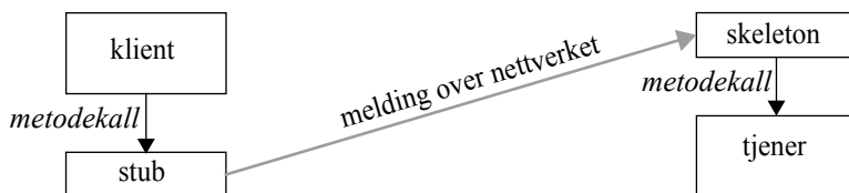
Figur 9-8: En RMI-konfigurasjon med stub- og skeleton-objekter
